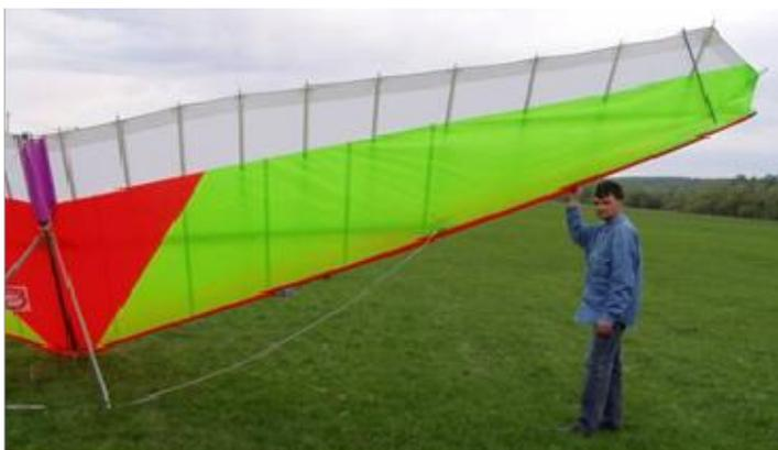
Обшивка крыла изготовлена из высокопрочной полиэфирной ткани и состоит из верхней и нижней поверхностей, килевого кармана и лобового обтекателя. С внутренней стороны верхней и нижней поверхностей пришиты латкарманы. Задняя кромка обшивки, а также участки, воспринимающие сосредоточенные нагрузки, имеют дополнительные усиления.
