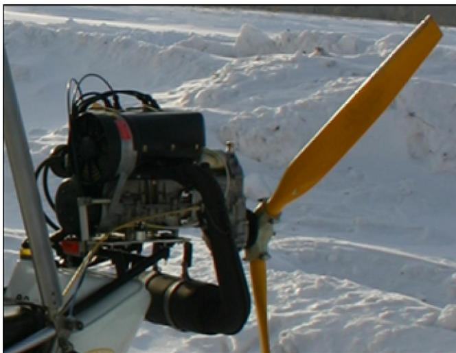
Винтомоторная группа состоит из двигателя, редуктора и воздушного винта.
